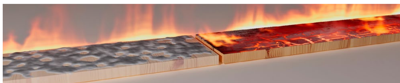
Isolierende Schaumschicht (links), die sich durch ein Feuer entwickelt und das beschichtete Holzbauteil (schwer entflammbar) zeitweise vor einer sofortigen Entzündung (rechts) schützt.
