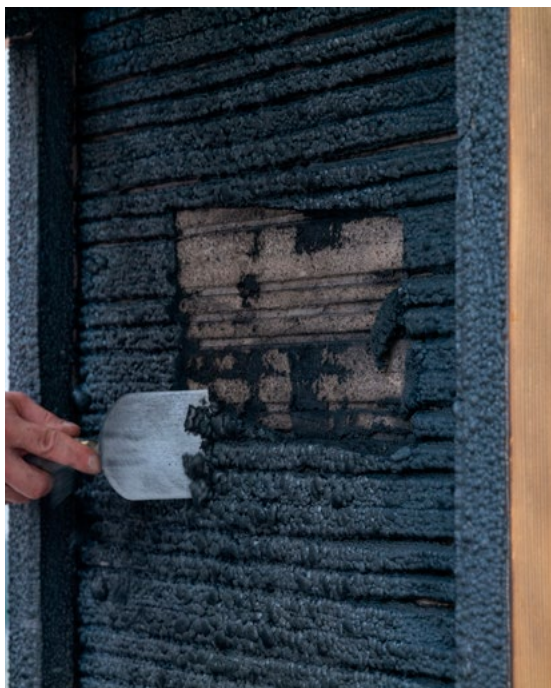
Entfernen des Kohlenstoffschaums von der Holzoberfläche nach Brandversuch
