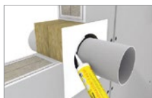
Verschließen des Ringspalts mit HENSOMASTIK® 5 KS SP
