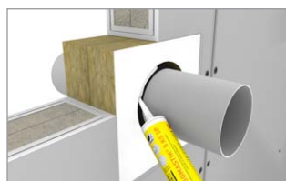
Verschließen des Ringspalts mit HENSOMASTIK® 5 KS SP
