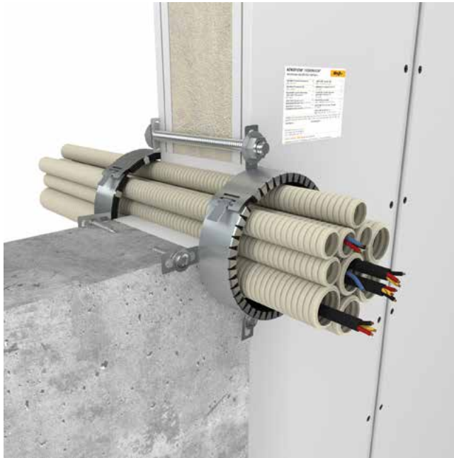
1 = Leichte Trennwand, 2 = HENSOTHERM® RM 50 (Größe und Art der Befestigung gem. Tabelle), 3 = Verschluss des max. 20 mm breiten Ringspalts mit Gipsspachtel (A1), Beton oder Zementmörtel, 4 = Bündel aus flexiblen Elektroinstallationsrohren (EIR) mit/ohne Kabel, 5 = Massivwand
