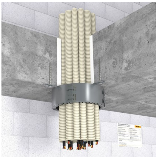
(1) Massivdecke (2) Ringspalt max. 20 mm breit verschlossen mit Gipsputz (A1), Beton oder Zementmörtel (3) HENSOTHERM® EM Modulrohrmanschette (4) Bündel aus flexiblen Elektroinstallationsrohren (EIR) mit Kabeln
