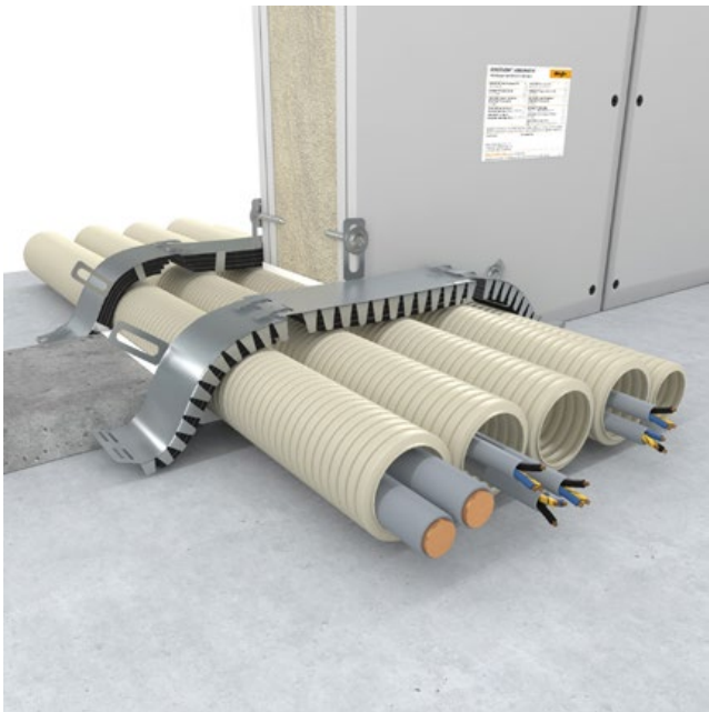
(1) Leichte Trennwand (2) Ringspalt max. 20 mm breit verschlossen mit Gipsspachtel (A1), Beton oder Zementmörtel (3) HENSOTHERM® EM Modulrohrmanschette (4) Leitungsverbund aus flexiblen Elektroinstallationsrohren (EIR) mit Kabeln (5) Massivwand (6) Massivdecke
