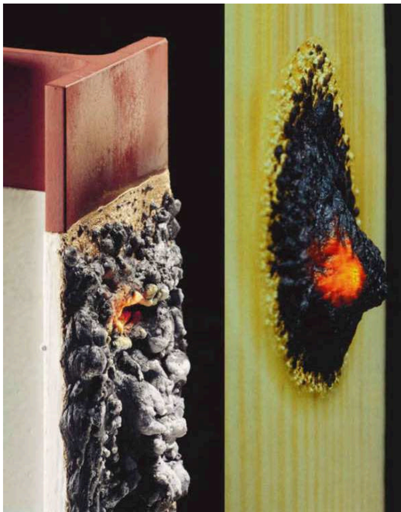
Dämmschichtbildende Brandschutzbeschichtungen erzeugen in einem durch die Hitze ausgelösten chemischen Prozess einen stabilen Kohlenstoffschaum. Die entstandene Schaumschicht hat einen gegen Wärme isolierenden Effekt und schützt so die darunterliegenden Materialien für einen in den Produktzulassungen definierten Zeitraum.
